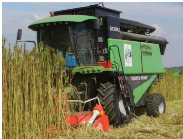
Moissonneuse batteuse modifiée avec un bec 6 rangs Kemper
