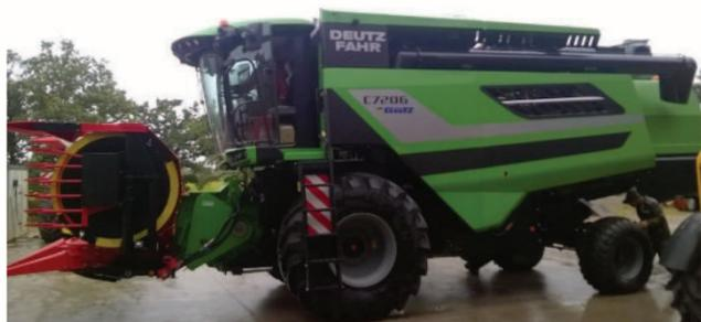
On distingue bien la chambre de coupe d'ensileuse Claas et le bec 6 rangs Kemper
